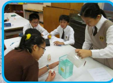
學生利用排水筒、量杯等工具，為物件進行體積的量度
